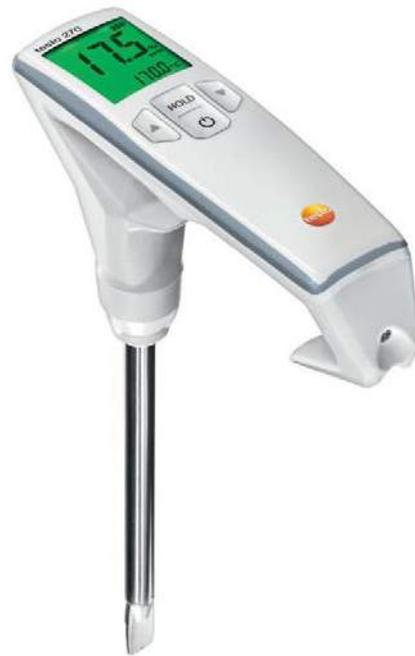
Figura 25: Tester dell'olio di frittura testo 270
