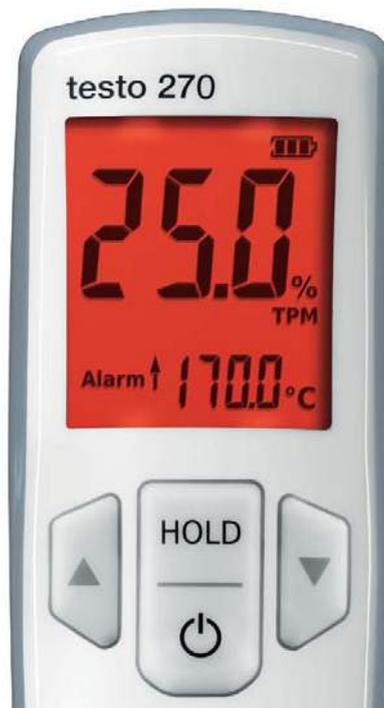
Figura 26: Allarme visivo se viene superato un dato limite
